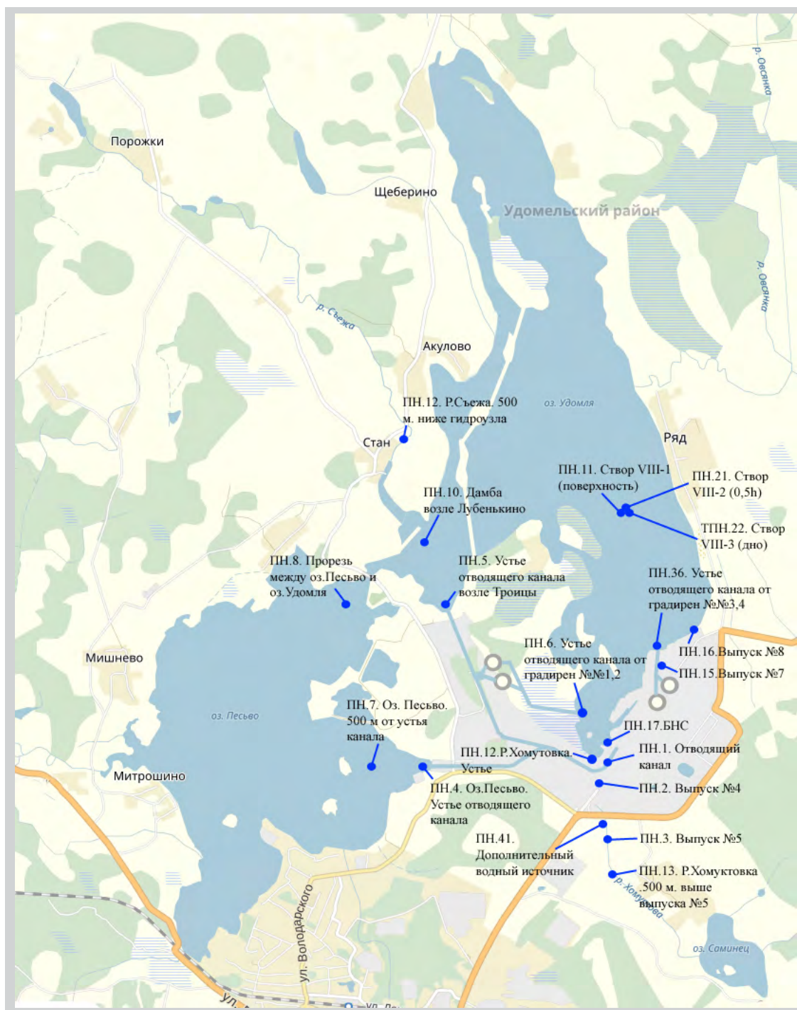
Рис. 5.4. Схема контроля гидрохимических показателей на водоеме-охладителе (водохранилище Калининской АЭС) в зоне наблюдения АЭС
