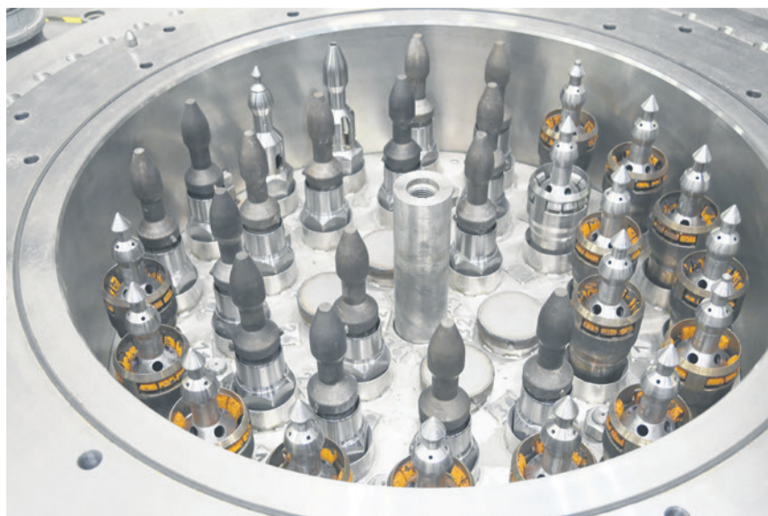
▼ Три из этих тепловыделяющих сборок с МОКС-топливом содержат нептуний и америций
